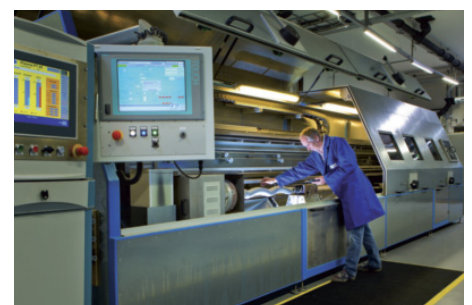
Plasmaspritzanlage am Fraunhofer IKTS in Hermsdorf.
