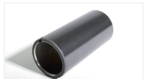
Wellen-schutzhülse mit schwarzer Chromoxid-Beschichtung zum Reduzieren der Reibverluste und zur Verlängerung der Lebensdauer von Wellen.
